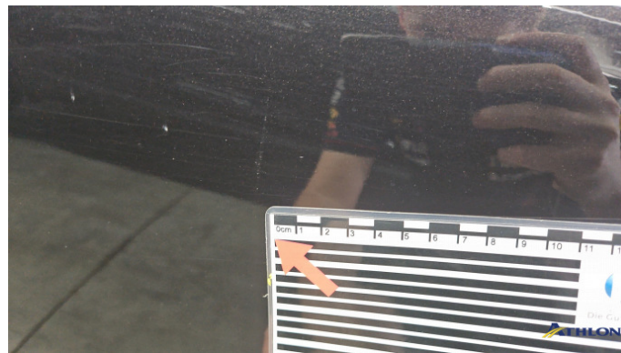
13. Tür Vorne - Rechts Kratzer
