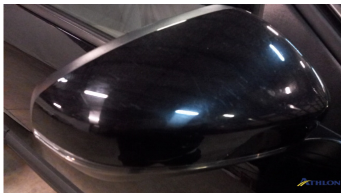
15. retrovisore esterno scatola - destro Graffi superficiali
