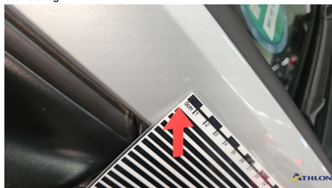
5. A-Säule Vorne - Rechts Steinschlag
