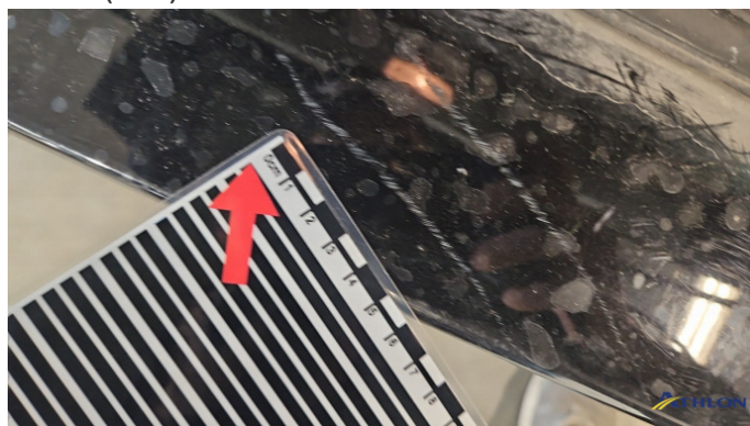
8. Stoßfänger Hinten Kratzer
