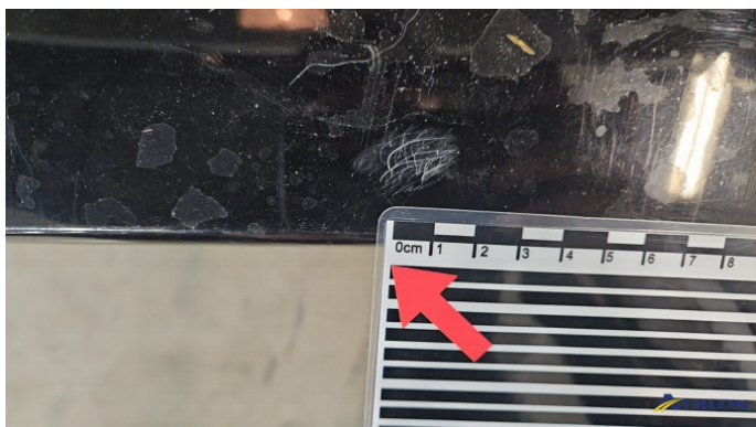
8. Stoßfänger Hinten Kratzer
