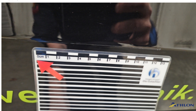
10. Tür Hinten - Rechts Kratzer Ab 60mm
