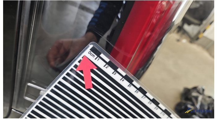
16. Rückleuchte Links Kratzer
