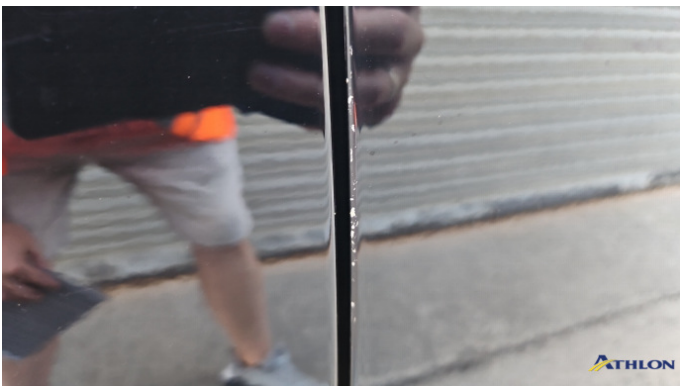
9. Tür Vorne - Rechts Kratzer
