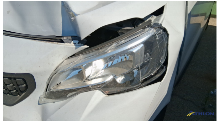
12. faro alogeno - sinistro Rotto
