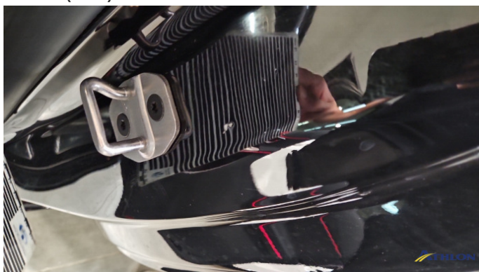
7. Türeinstieg Hinten - Links Verformt (leicht)
