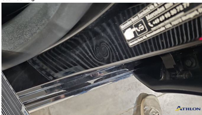
6. Türeinstieg Vorne - Links Verformt (leicht)
