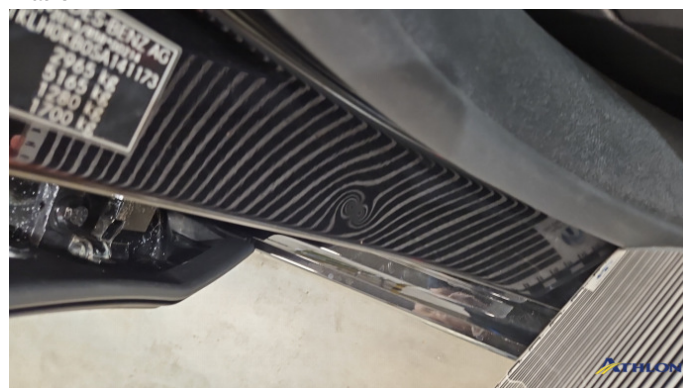
12. Türeinstieg Vorne - Rechts Verformt (leicht)
