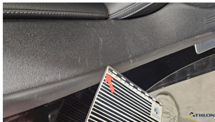
20. Türeinstieg Hinten - Rechts Verkleidung Gebrauchsspuren
