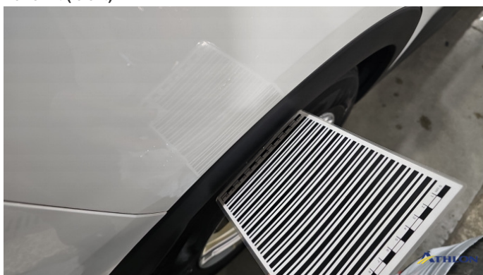
3. Seitenwand - Hinten - Rechts Verformt (leicht)
