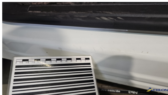
6. Türeinstieg Vorne - Links Kratzer
