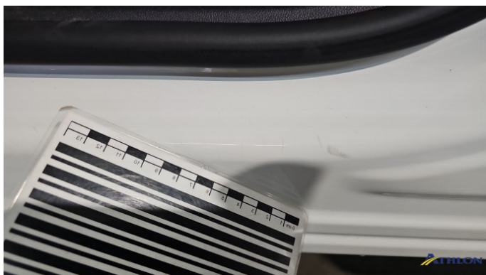
6. Türeinstieg Vorne - Links Kratzer
