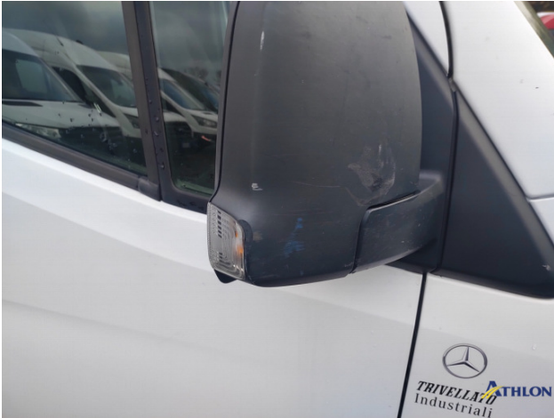
14. retrovisore esterno scatola - destro Rotto
