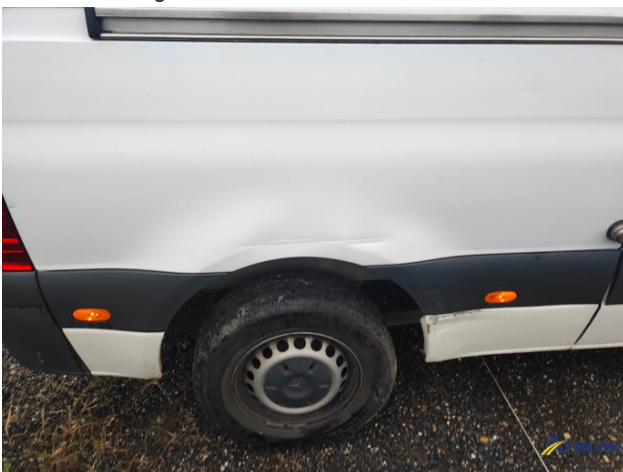
10. parete laterale - posteriore - destra Ammaccature/rigonfiamenti
