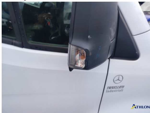
14. retrovisore esterno scatola - destro Rotto
