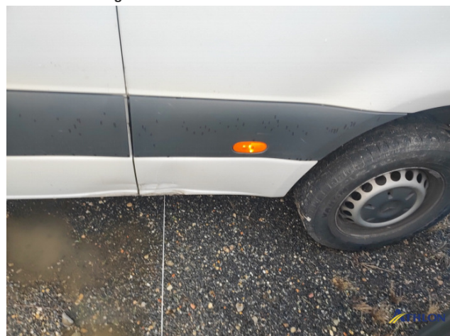
7. parete laterale - posteriore - sinistra Ammaccature/rigonfiamenti
