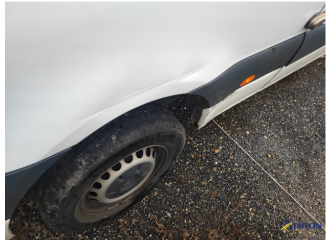
10. parete laterale - posteriore - destra Ammaccature/rigonfiamenti
