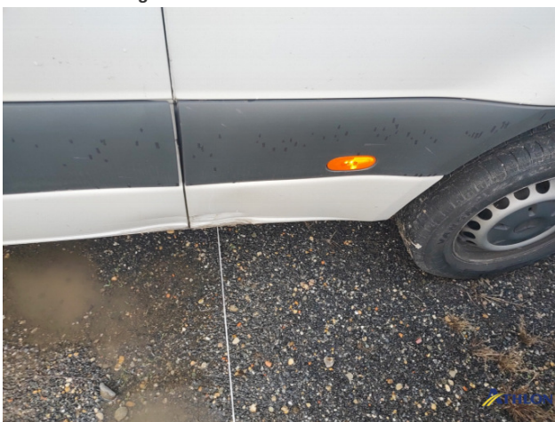
7. parete laterale - posteriore - sinistra Ammaccature/rigonfiamenti
