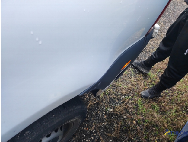
7. parete laterale - posteriore - sinistra Ammaccature/rigonfiamenti
