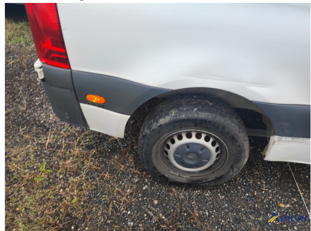
10. parete laterale - posteriore - destra Ammaccature/rigonfiamenti
