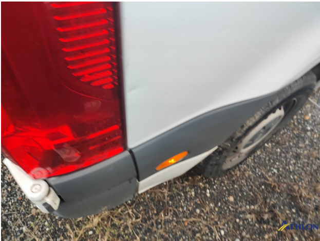
10. parete laterale - posteriore - destra Ammaccature/rigonfiamenti
