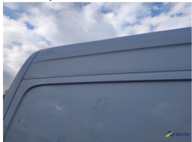
10. parete laterale - posteriore - destra Ammaccature/rigonfiamenti
