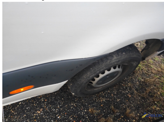
7. parete laterale - posteriore - sinistra Ammaccature/rigonfiamenti
