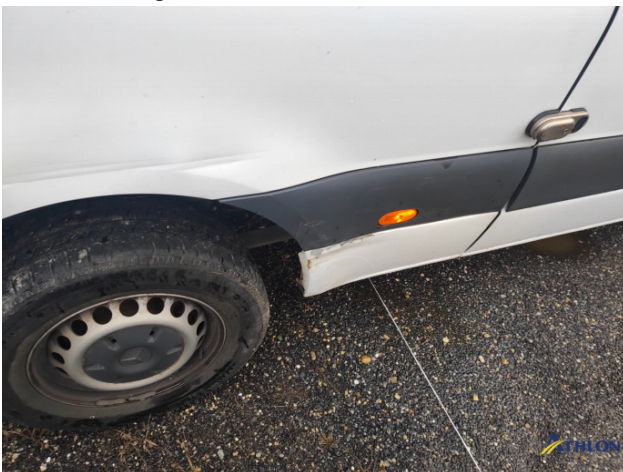
10. parete laterale - posteriore - destra Ammaccature/rigonfiamenti
