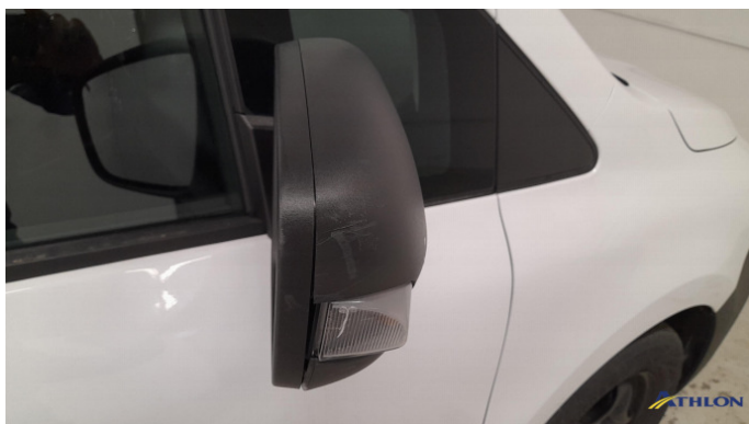
12. retrovisore esterno scatola - destro Rotto
