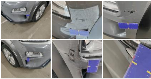
Fog lamp R, Scratch(es), Replace
