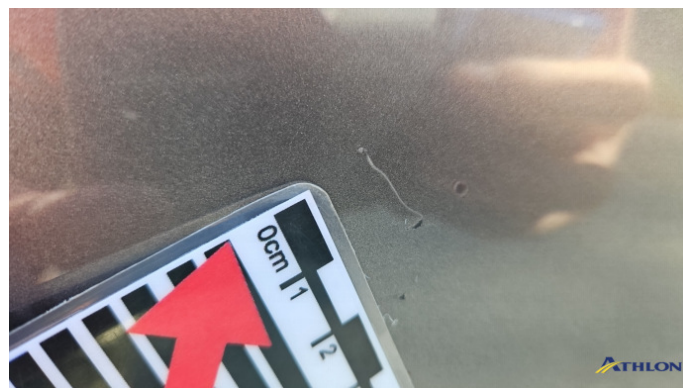
8. Tür Hinten - Rechts Kratzer
