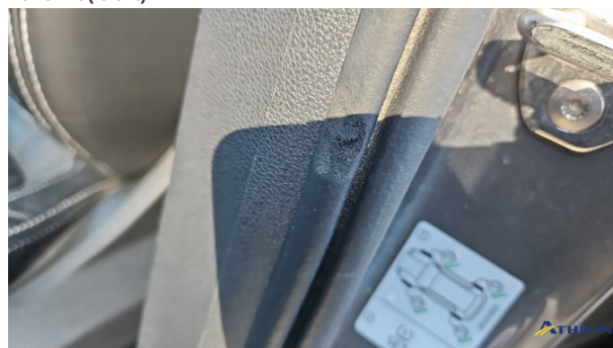
12. Türdichtung Vorne - Links Beschädigt
