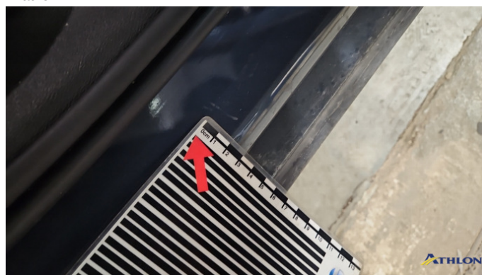
10. Türeinstieg Hinten - Rechts Kratzer
