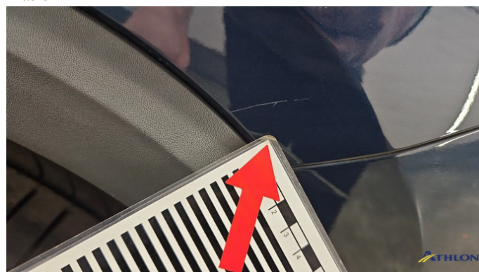
5. Seitenwand - Hinten - Links Kratzer
