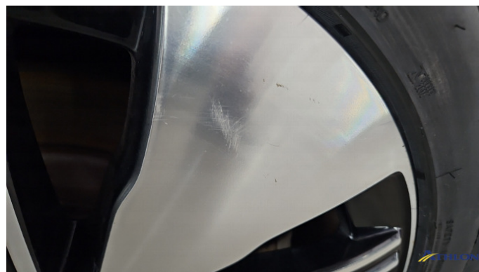
6. Felge Hinten - Links Kratzer
