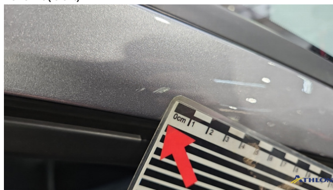
5. A-Säule Vorne - Rechts Kratzer
