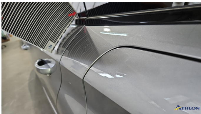
1. Seitenwand - Hinten - Links 1 Delle
