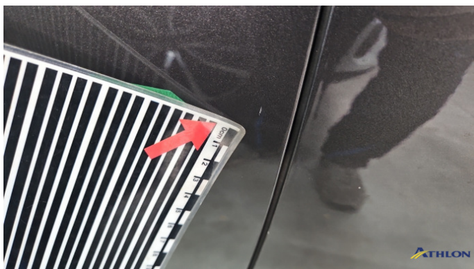
9. Tür Hinten - Rechts Kratzer
