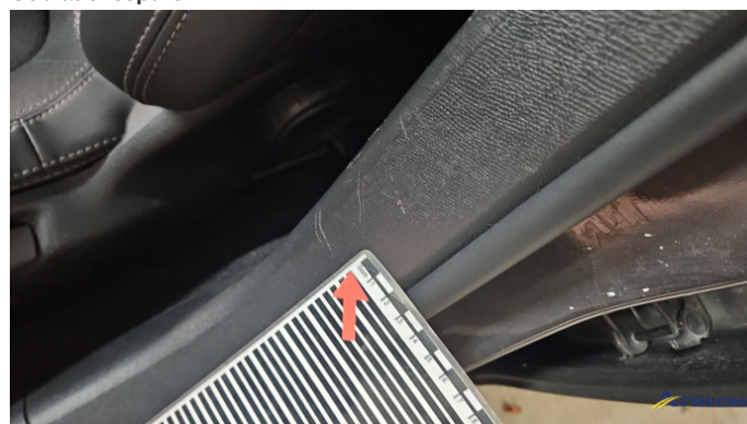
14. Türeinstieg Vorne - Links Verkleidung Gebrauchsspuren
