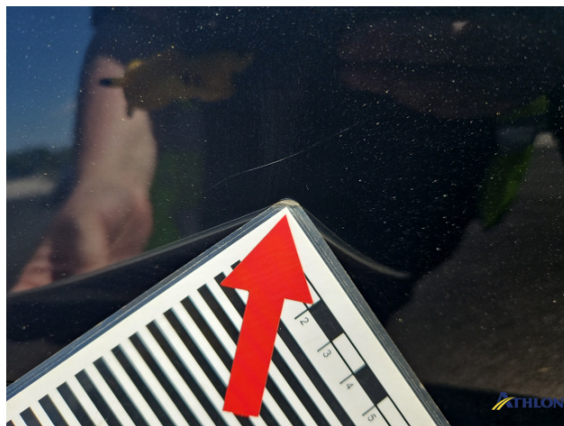
1. Seitenwand - Hinten - Rechts Klarlackabplatzer
