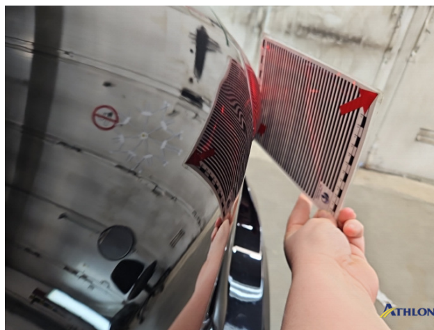
7. Heckklappe Verformt (leicht)
