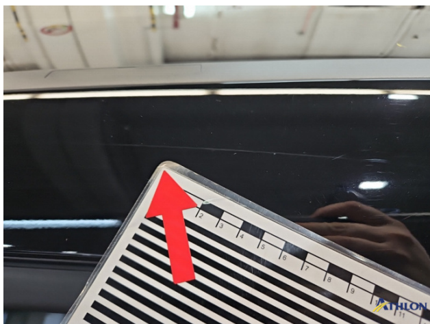
6. Dachrahmen - Links Kratzer
