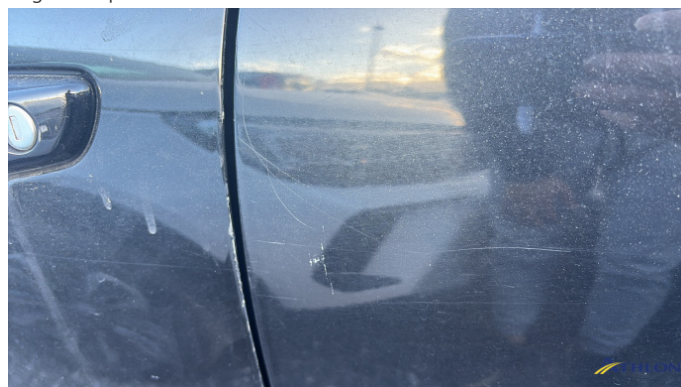
1. porta anteriore - sinistra Ammaccature/rigonfiamenti
