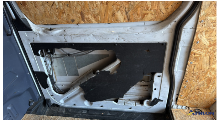
18. Pannelli interni Rotto
