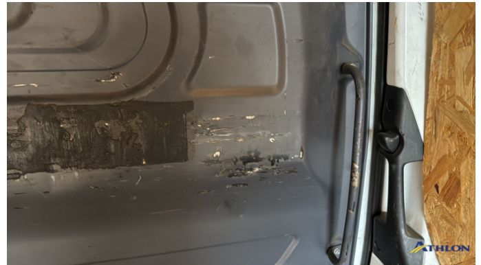
19. Parete divisoria cabina - PRM Graffio/Rigature
