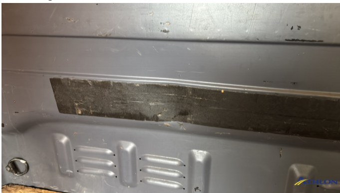
19. Parete divisoria cabina - PRM Graffio/Rigature
