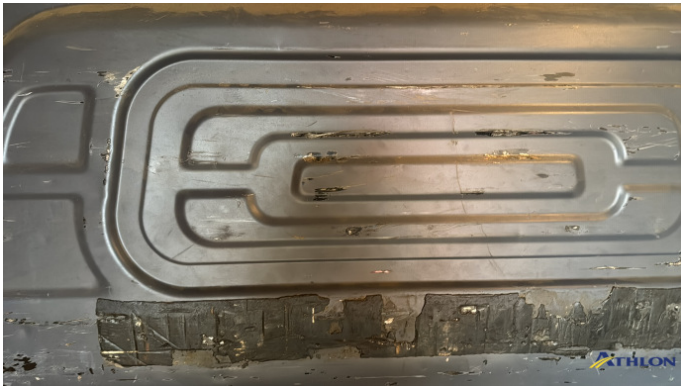
19. Parete divisoria cabina - PRM Graffio/Rigature
