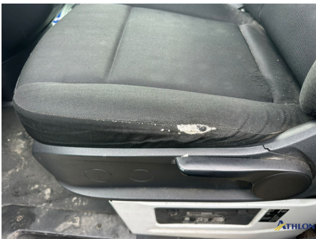
21. fodero sedile ant sx Rotto
