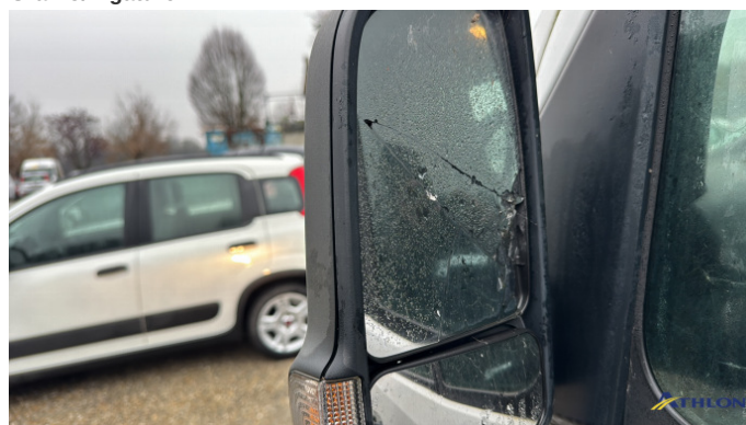
6. retrovisore esterno scatola - sinistro Rotto
