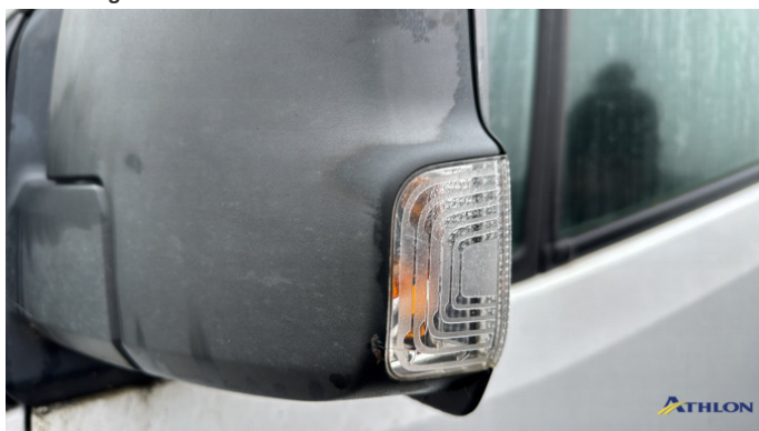
6. retrovisore esterno scatola - sinistro Rotto
