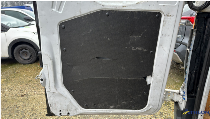
18. Pannelli interni Rotto
