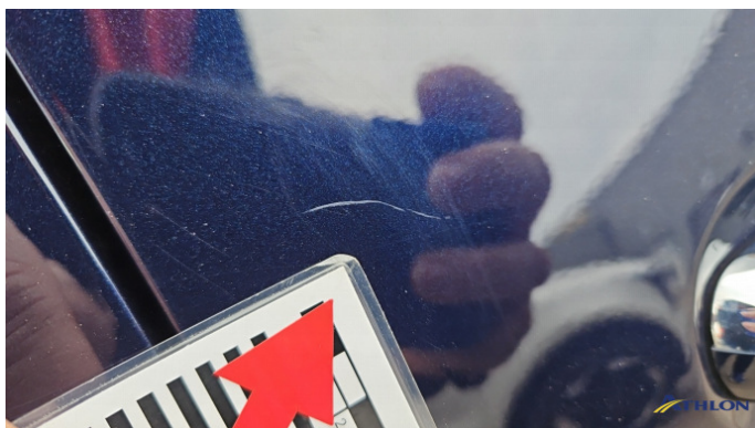
8. Tür Vorne - Rechts Kratzer
