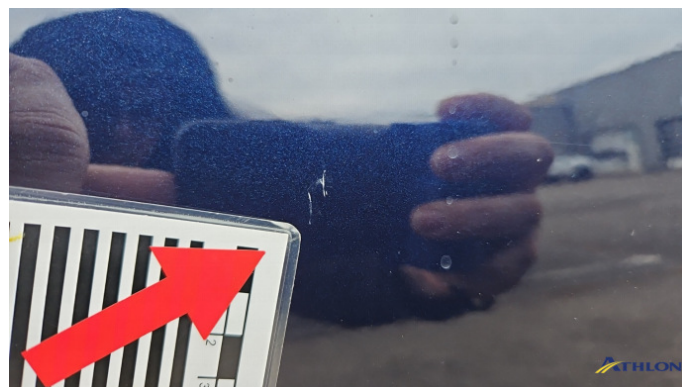
8. Tür Vorne - Rechts Kratzer
