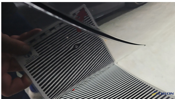
11. Seitenwand - Hinten - Rechts 1 Delle
