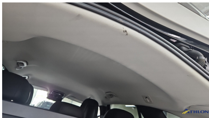
20. Dachhimmel Verschmutzt (mittel)
