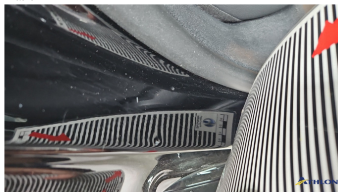
13. Türeinstieg Hinten - Rechts Kratzer
