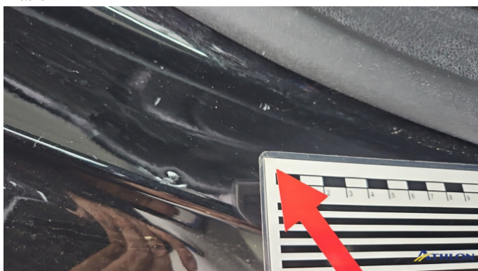
13. Türeinstieg Hinten - Rechts Kratzer
