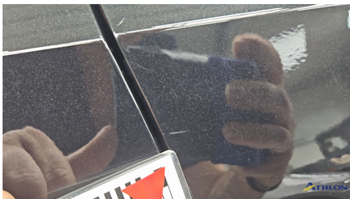
14. Tür Vorne - Rechts Kratzer
