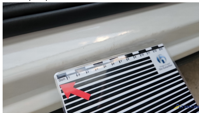
11. Türeinstieg Vorne - Rechts Kratzer
