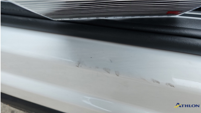
4. Türeinstieg Vorne - Links Verformt (leicht)
