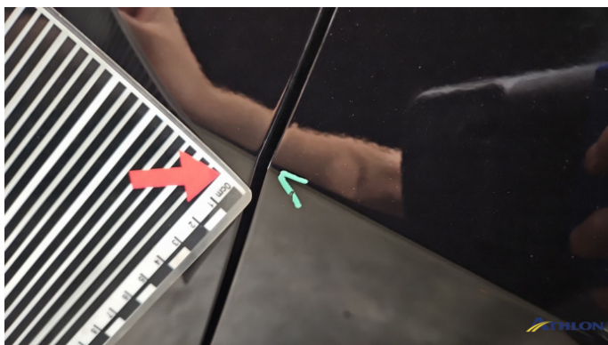
7. Tür Vorne - Rechts Kratzer
