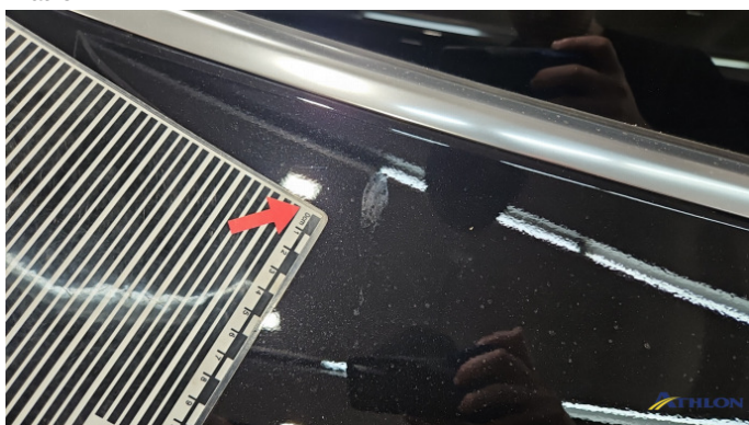
5. Seitenwand - Hinten - Rechts Umweltschaden
