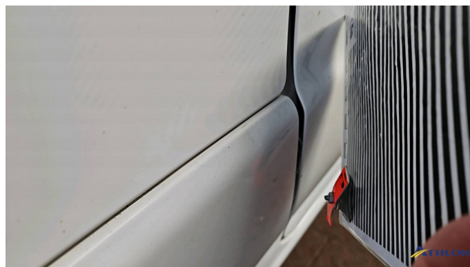
6. B-Säule Mitte - Rechts 1 Delle
