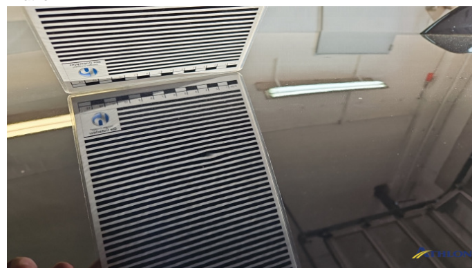
6. Dach 5 Dellen Nicht In Ordnung
