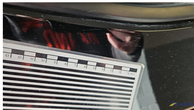
4. Tür Hinten - Rechts Kratzer
