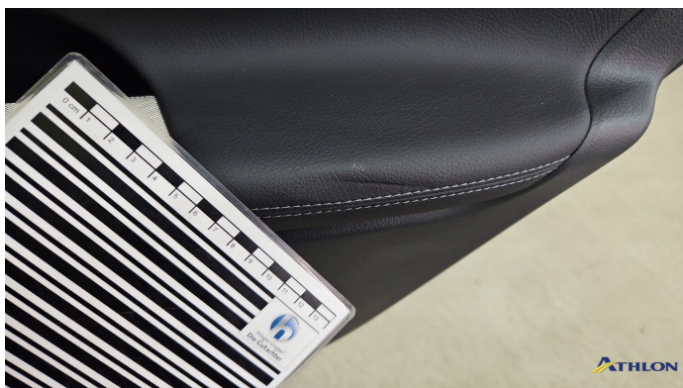
5. Türverkleidung Hinten - Rechts Verformt (leicht)
