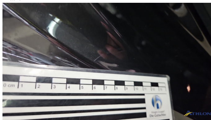
4. Türeinstieg Hinten - Rechts Kratzer
