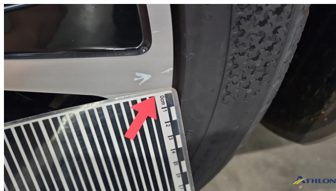
3. Felge Hinten - Links Kratzer
