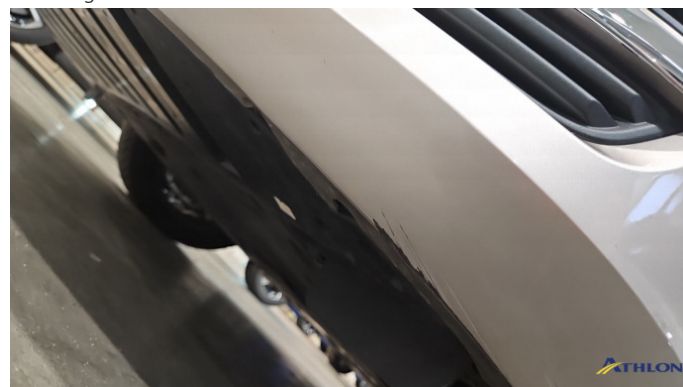
1. Stoßfänger Vorne Kratzer Ab 60mm
