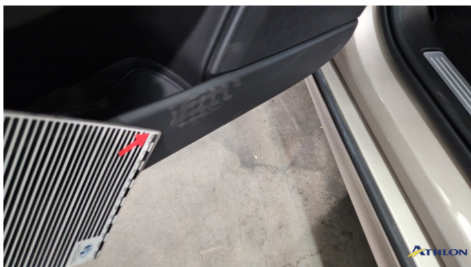
6. Türverkleidung Vorne - Links Gebrauchsspuren
