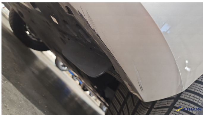
1. Stoßfänger Vorne Kratzer Ab 60mm
