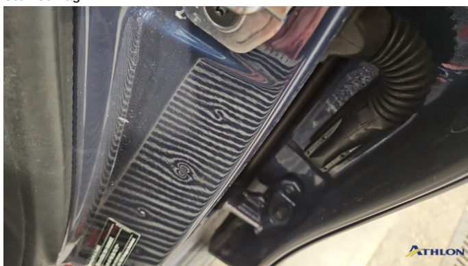
3. Türeinstieg Vorne - Links Verformt (leicht)
