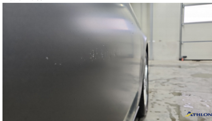
4. Tür Vorne - Rechts Verformt (leicht)
