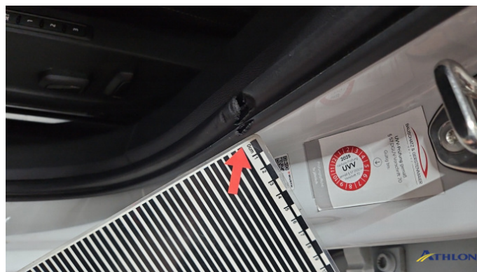
15. Türdichtung Vorne - Links Beschädigt
