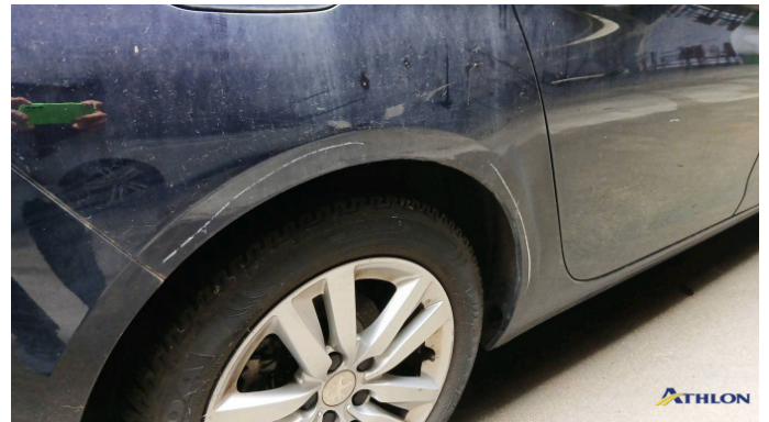
13. parete laterale - posteriore - destra Graffio/Rigature
