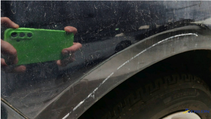
13. parete laterale - posteriore - destra Graffio/Rigature
