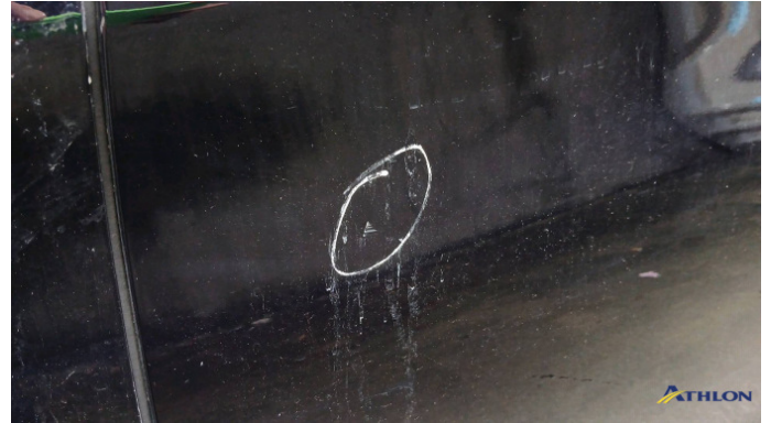
5. porta posteriore - sinistra 1 ammaccatura
