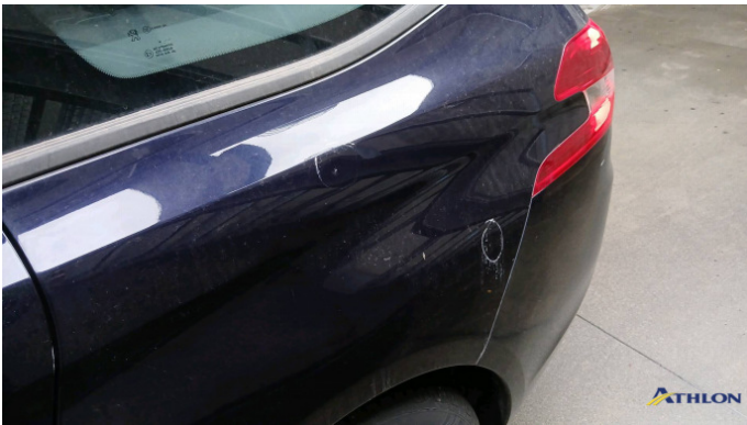
18. parete laterale - posteriore - sinistra 2 ammaccature
