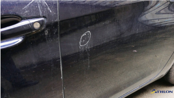
5. porta posteriore - sinistra 1 ammaccatura
