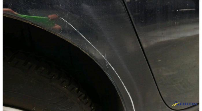
13. parete laterale - posteriore - destra Graffio/Rigature
