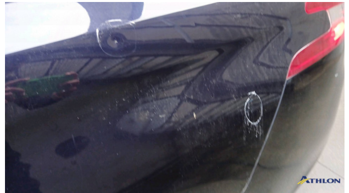
18. parete laterale - posteriore - sinistra 2 ammaccature
