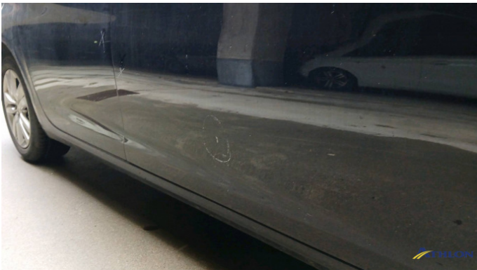
9. porta anteriore - destra 1 ammaccatura
