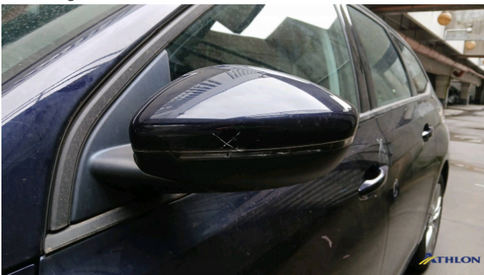
7. retrovisore esterno scatola - sinistro Graffio/Rigature
