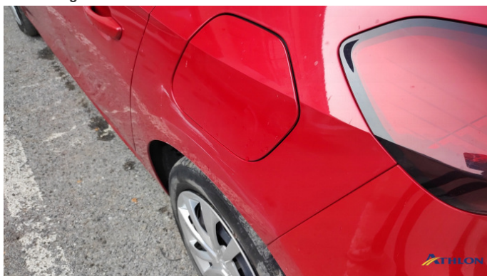
4. parete laterale - posteriore - sinistra Ammaccature/rigonfiamenti
