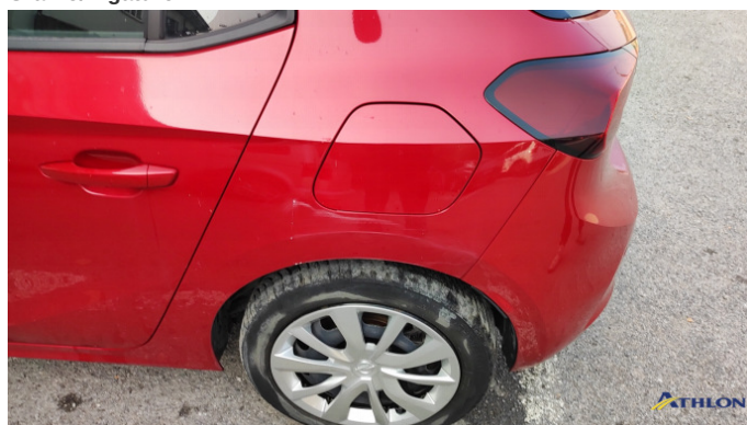
4. parete laterale - posteriore - sinistra Ammaccature/rigonfiamenti
