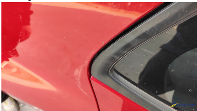
7. parete laterale - posteriore - destra Ammaccature/rigonfiamenti
