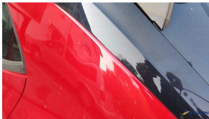
14. parete laterale - posteriore - sinistra Ammaccature/rigonfiamenti
