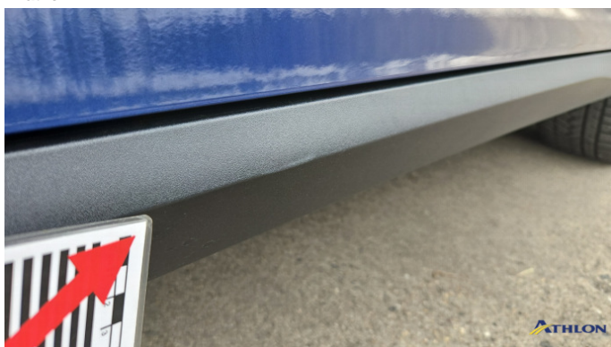
7. Schweller - Rechts Kratzer
