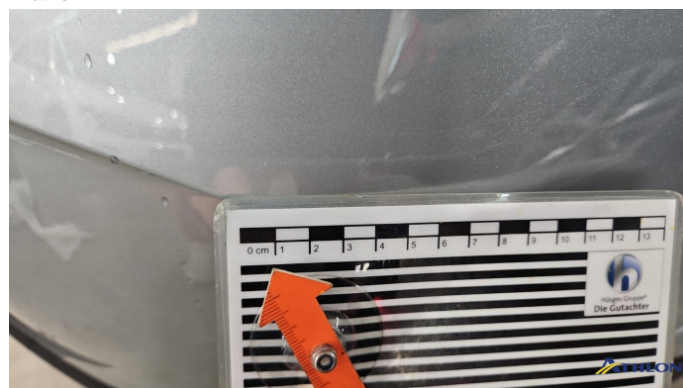
4. Stoßfänger Hinten Kratzer
