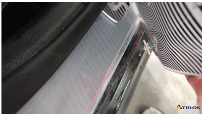
5. Türeinstieg Vorne - Rechts Verformt (leicht)
