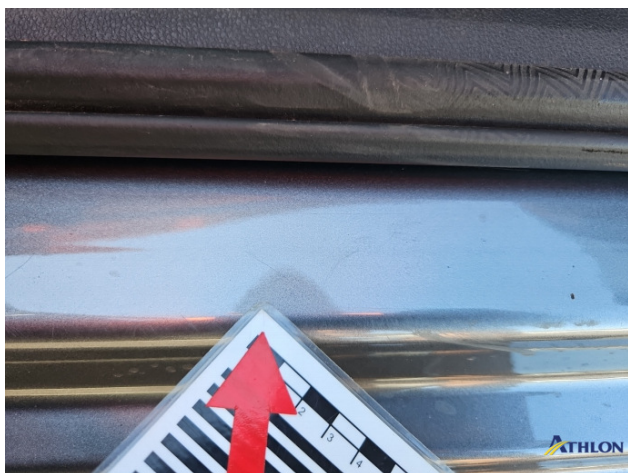
3. Türeinstieg Vorne - Links Kratzer
