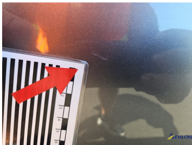
8. Tür Vorne - Links Kratzer
