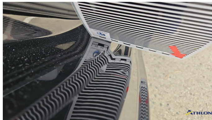
11. Türeinstieg Hinten - Rechts Verformt (leicht)
