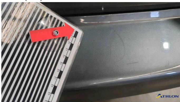
7. Stoßfänger Hinten Kratzer Ab 60mm
