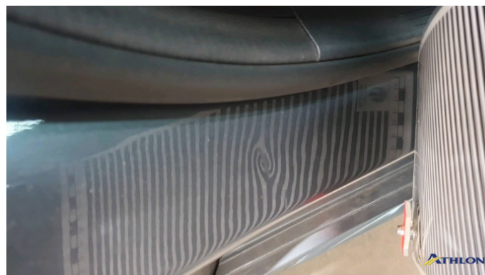
10. Türeinstieg Hinten - Rechts Verformt (leicht)
