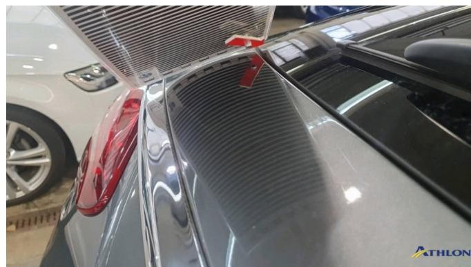
6. Heckklappe Verformt (leicht)
