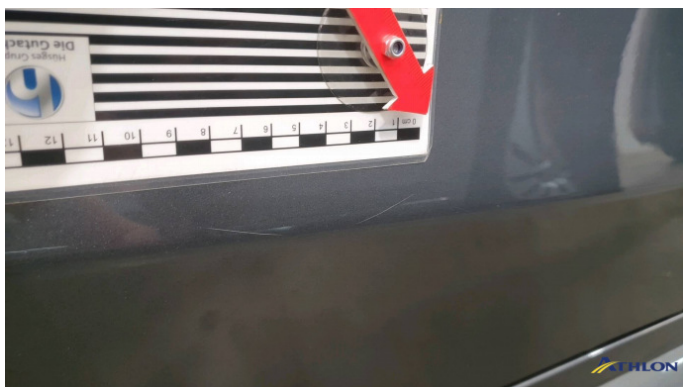
9. Tür Hinten - Rechts Kratzer
