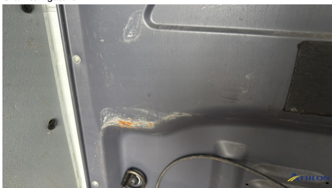
12. Parete divisoria cabina - PRM Graffio/Rigature
