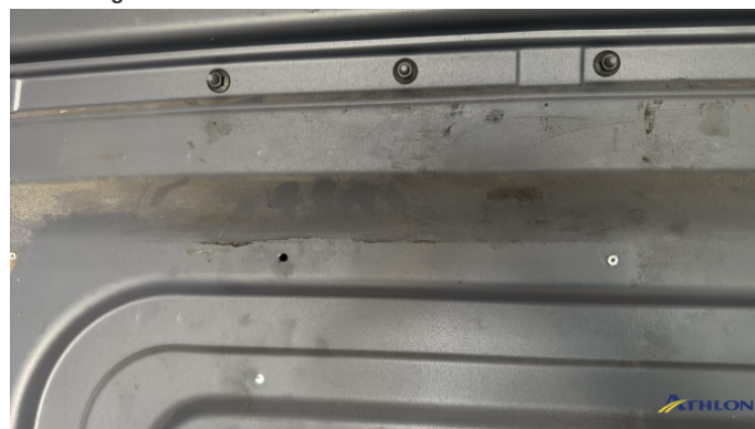
12. Parete divisoria cabina - PRM Graffio/Rigature
