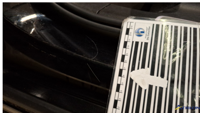
1. Türeinstieg Hinten - Links Kratzer
