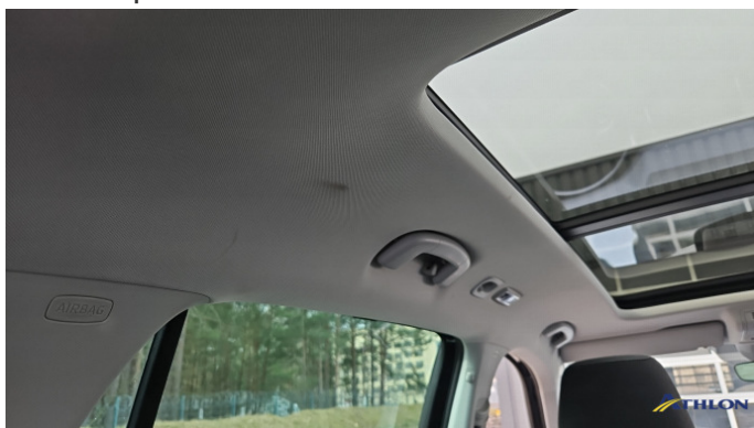
19. Dachhimmel Verschmutzt (mittel)
