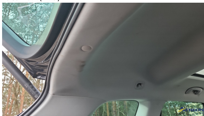
19. Dachhimmel Verschmutzt (mittel)
