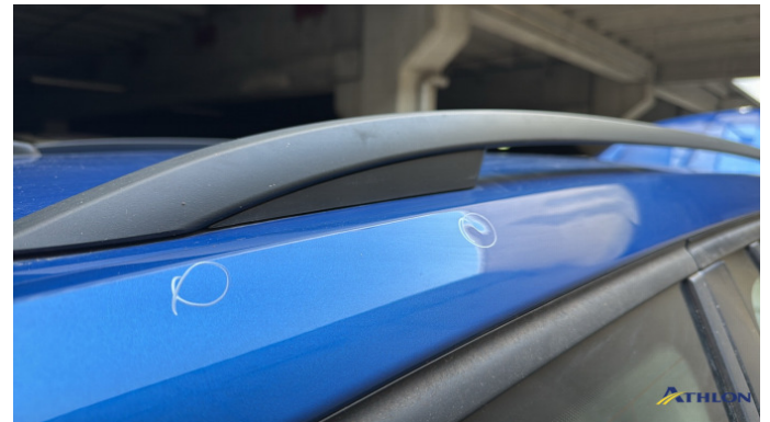
4. telaio del tetto - destro 1 ammaccatura
