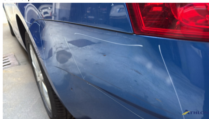
15. parete laterale - posteriore - sinistra 1 ammaccatura
