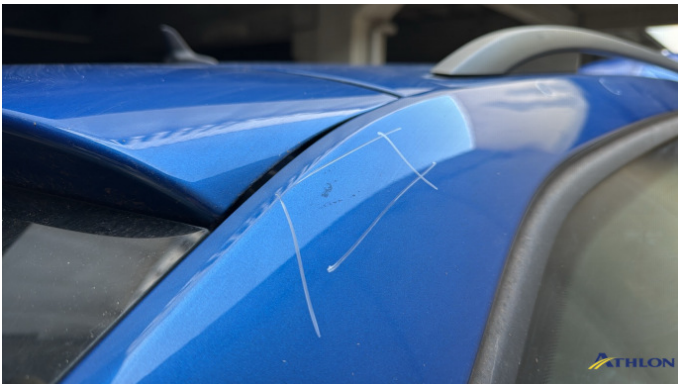
4. telaio del tetto - destro 1 ammaccatura
