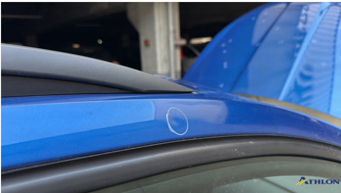
4. telaio del tetto - destro 1 ammaccatura
