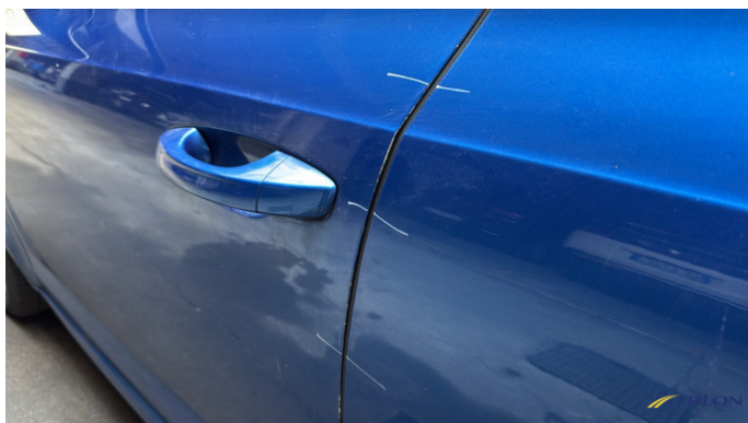
13. B-colonna centrale - sinistra Graffi superficiali
