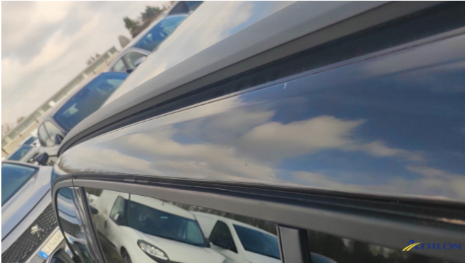
11. telaio del tetto - sinistro Ammaccature/rigonfiamenti
