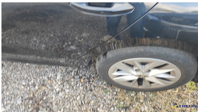
14. parete laterale - posteriore - sinistra Ammaccature/rigonfiamenti
