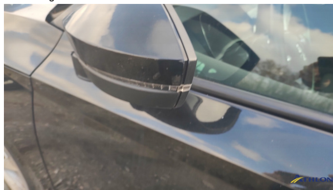
10. retrovisore esterno scatola - sinistro Graffio/Rigature
