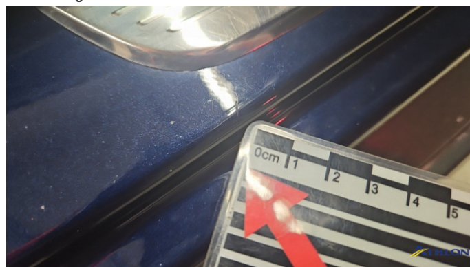
5. Türeinstieg Vorne - Rechts Kratzer
