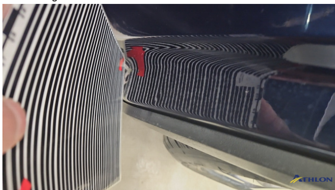
4. Türeinstieg Hinten - Links Verformt (leicht)
