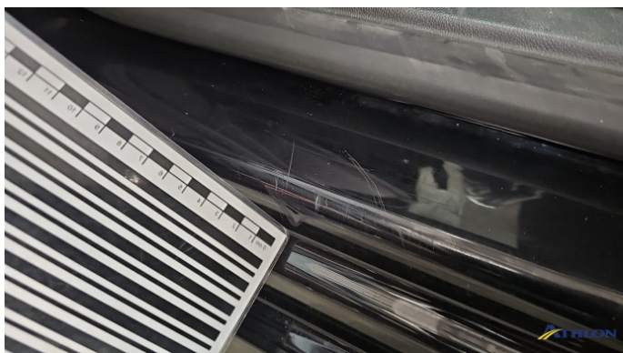
11. Türeinstieg Vorne - Links Kratzer
