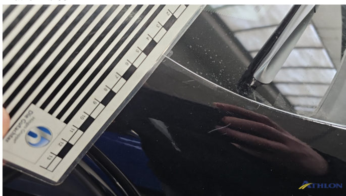
9. A-Säule Vorne - Rechts Kratzer
