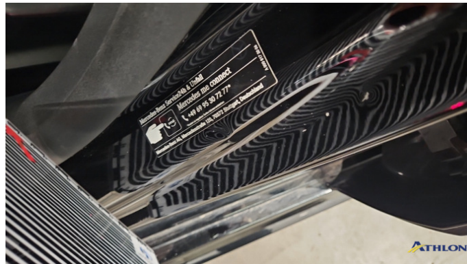
6. Türeinsteig Vorne - Links Verformt (leicht)
