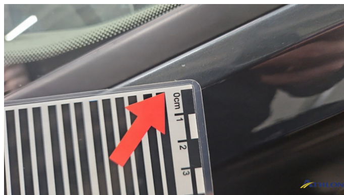
5. A-Säule Vorne - Links Steinschlag
