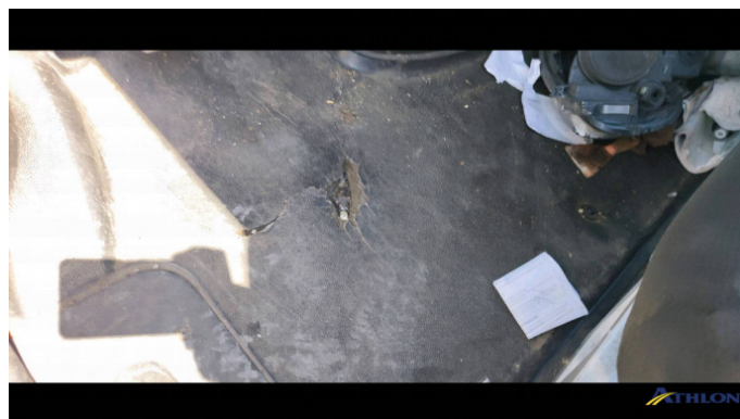
18. Pavimento ant. Rotto
