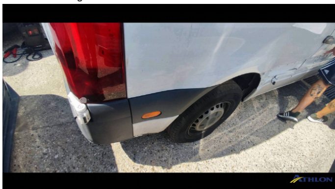
12. parete laterale - posteriore - destra Ammaccature/rigonfiamenti
