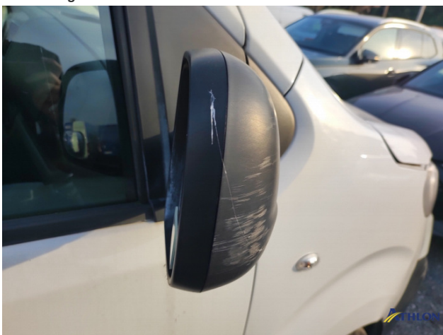
6. retrovisore esterno scatola - destro Rotto
