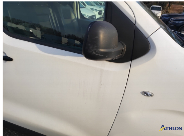
6. retrovisore esterno scatola - destro Rotto
