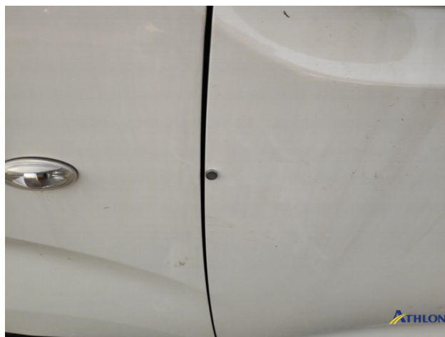
12. porta anteriore - sinistra Difetto di esecuzione
