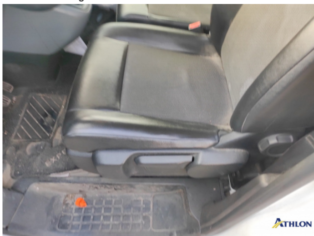
16. fodero sedile ant sx Rotto
