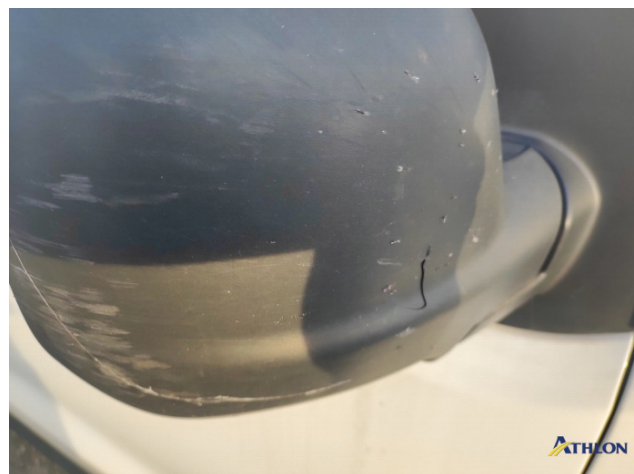
6. retrovisore esterno scatola - destro Rotto
