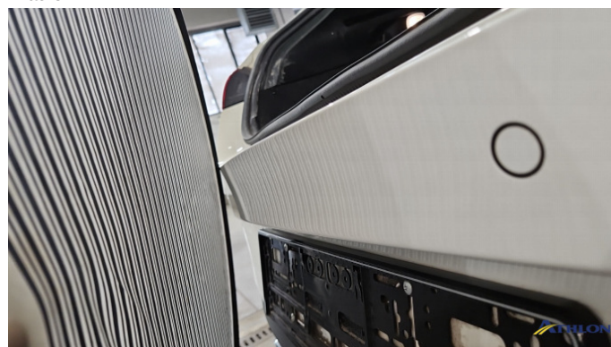
10. Stoßfänger Hinten 2 Dellen
