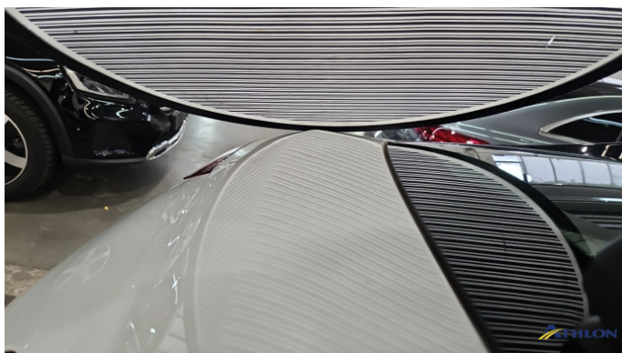
6. Heckklappe Verformt (leicht)
