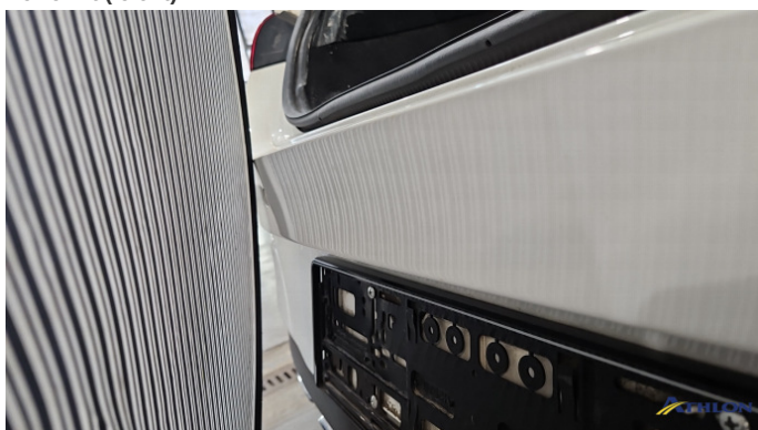
10. Stoßfänger Hinten 2 Dellen
