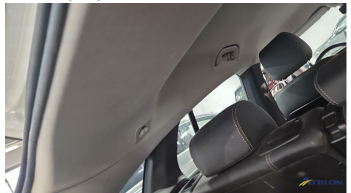
19. Dachhimmel Verschmutzt (mittel)
